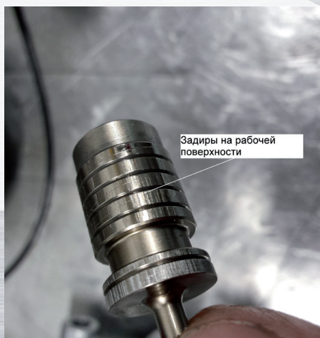
Редукционный клапан насоса и его посадочное отверстие со следами задирки
