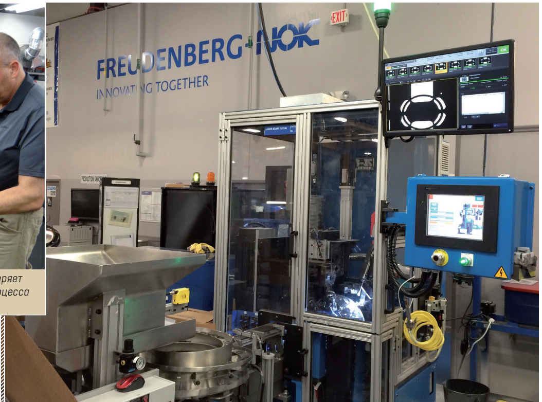
Современный высокотехнологичный станок для резки со скосом кромки с функцией лазерной разметки. Он оборудован видеосистемой, которая фиксирует основные размеры и контролирует лазерное травление (предприятие в Финдли, Огайо)
